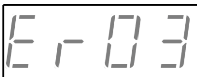
Rysunek 8.2. Przykład wyświetlenia uszkodzenia o numerze 3
