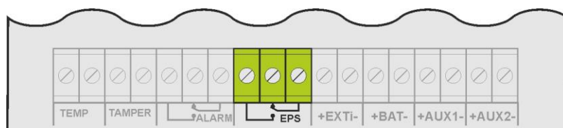
Rys. 8. Wyjście techniczne EPS.
